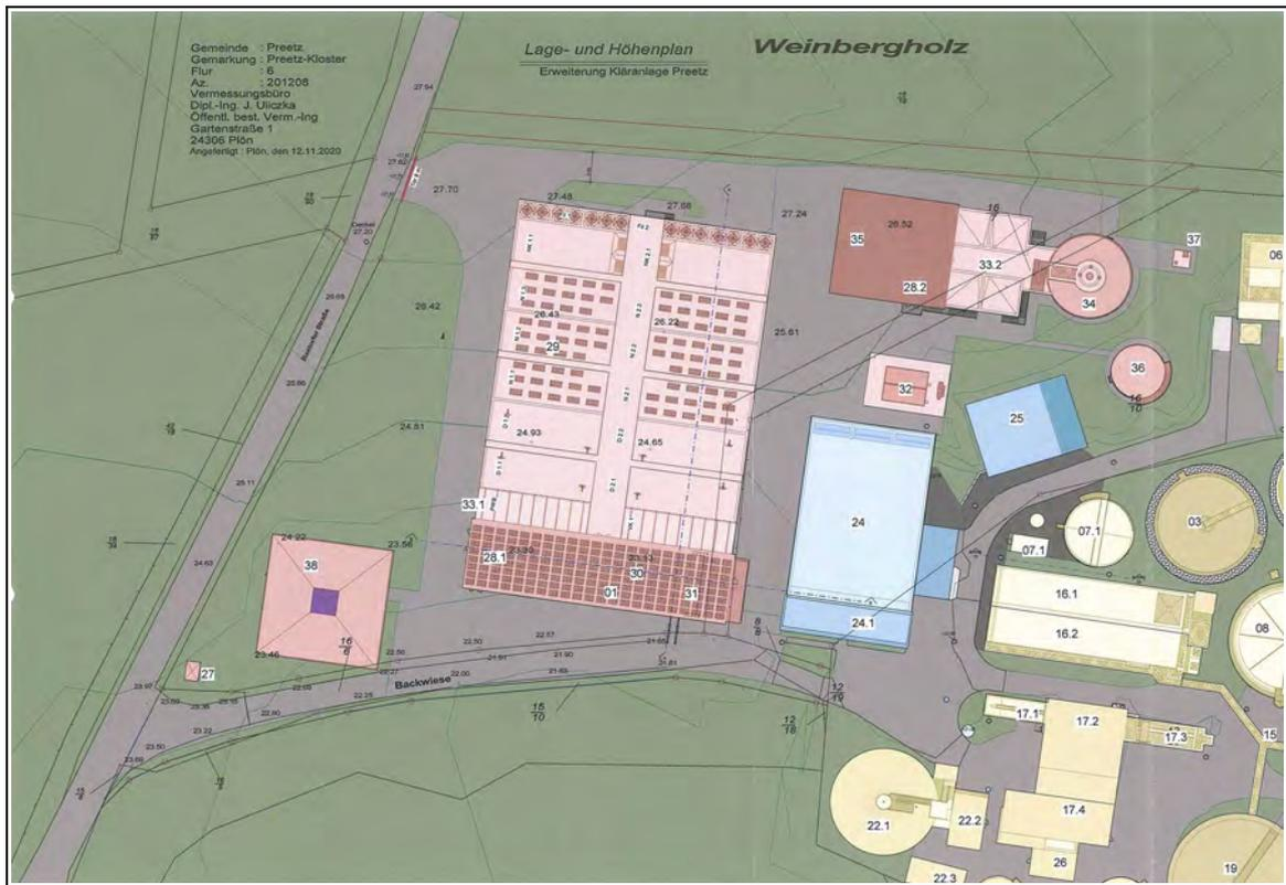
Abb.: Neubau der Kläranlage Preetz, Lageplan / Oberflächenplan (AZV, 14.04.22)
