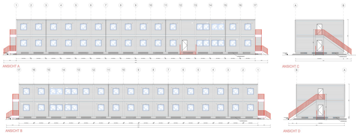
Abb.: Standardansichten zum Modul Typ A (Architektin Geißel-Born, Februar 2024; o.M.)
