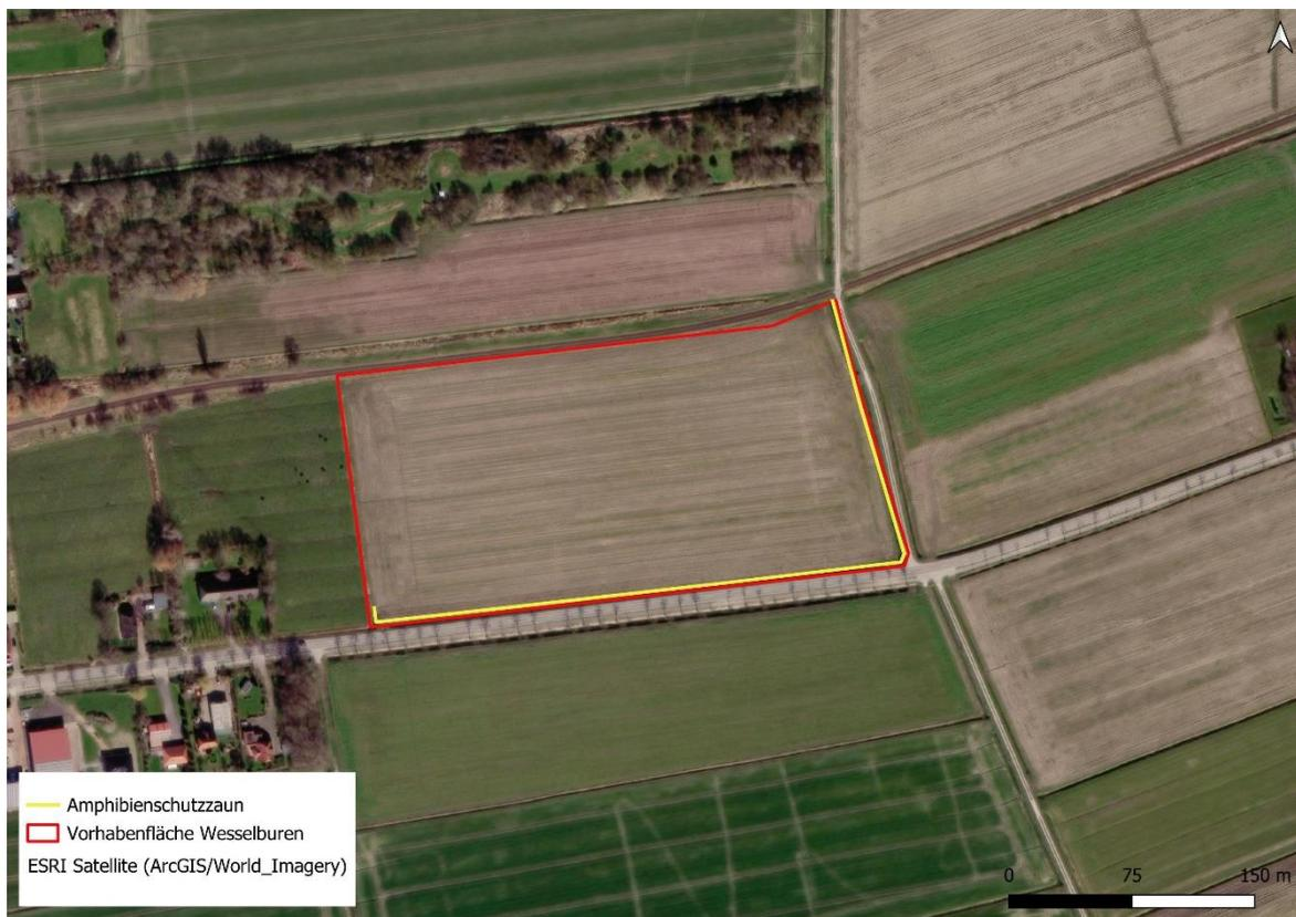
Abb. 5.1 *Empfohlene Positionierung des Amphibienschutzzaunes zum Bau der Unterkünfte in Wesselburen.*
