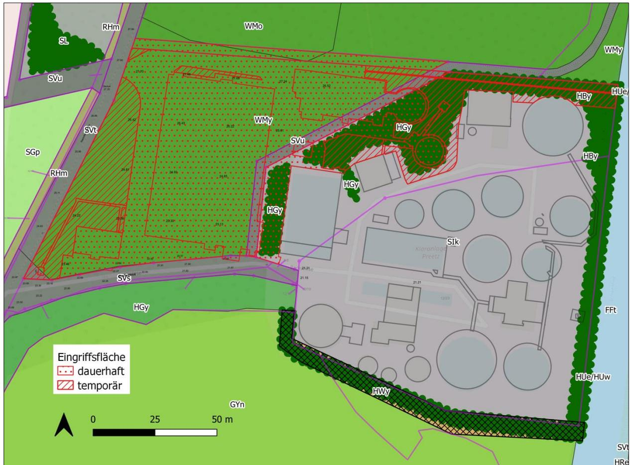
Abb. 5: Lageplan temporäre Eingriffe (rot schraffiert) und dauerhafter Eingriff (gepunktet rot).
